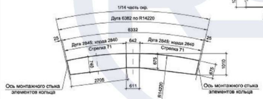
Геометрическая схема настила элемента опорного кольца
